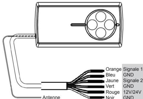
(A) Après le raccordement des fils aux bornes de la carte électronique, appuyer sur le Bouton d'Essai pour tester si la sortie 1 est en fonction.
