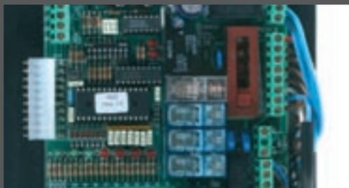
Bornier extractible à permettre la plus grande efficacité pendant les opérations d'installation
