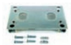
Plaque d'ancrage relevée. Entraxe du système de pattes au sol 280 x 170, n.4 Ø 11. Entraxe du fixation moteur 269 x 106 n.4 M10.
