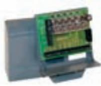
Fiche électronique qui permet le mouvement synchrone de 2 automatons
