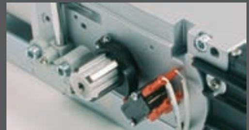
Complet et compact, le moteur est équipé de fins de courses électromécaniques qui permettent une fermeture parfaite
