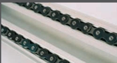
Le mouvement est silencieux et régulier grâce à la chaîne robuste et autolubrifiante guidée par le rail
