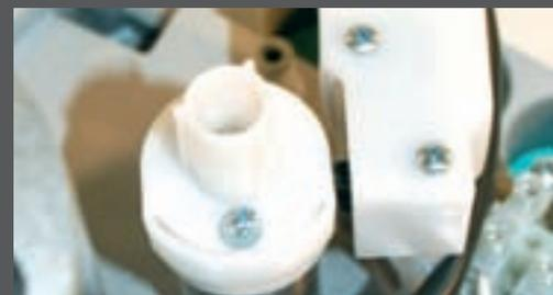
Fins de courses électromécaniques incorporées actionnées par cames facilement réglables
