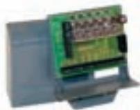
Fiche électronique qui permet le mouvement synchrone de 2 automatisations
