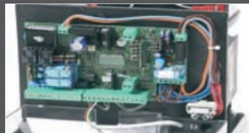
La version 24 Vdc est équipée de charge-batterie incorporé dans la centrale pour le fonctionnement pendant coupure de courant
