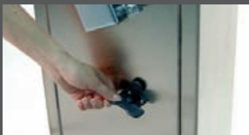
En cas d'urgence la barrière peut être déblocuée aisément et manoeuvrée manuellement
