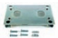
Plaque d'ancrage relevée Entraxe du système de pattes au sol 280 x 170, n.4 Ø 11. Entraxe du fixation moteur 269 x 106 n.4 M10
