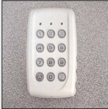
TALOS2B : clavier à codes en saillie, boîtier ABS, 2 relais NO NF, 12/24 V AC/DC, bi stable, impulsionnel, temporisé, rétro-éclairé anti-arrachement. 60 codes programmables en façade.
