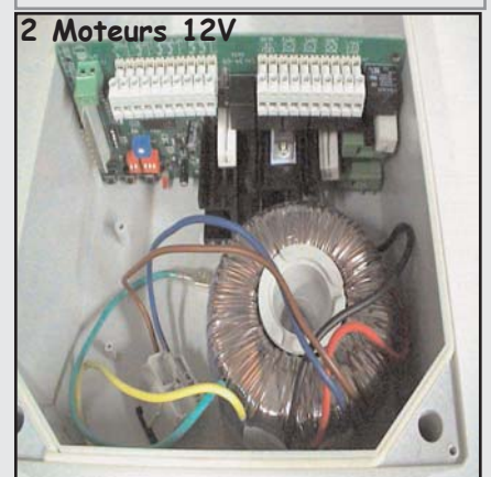
CTR34S : Le nouveau coffret de commande pour 2 moteurs en 12V .Le transfo est indépendant afin de faciliter le SAV , le circuit est miniaturisé afin de libérer de l'espace pour le câblage et la batterie , il intègre toutes les fonctions habituelles .Attention il faut impérativement connaître la consommation de vos moteurs !
