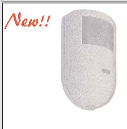
IRIS2 : Radar infra rouge filaire, avec mémoire d'alarme, led de signalisation d'alarme. Alimentation 13Vcc, Absorption max. 10mA, portée 15mètres max , angle de couverture H : 90° V : 90° , dimensions 79x58x50mm.9.9Ghz.
