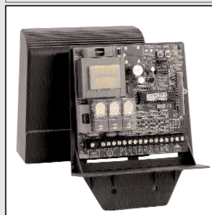
DA2XS433 : Coffret de commande pour moteur 500W. Préclignotement, serrure électrique. Programmation avec refermeture automatique. Fonctionnement collectif. Récepteur 433Mhz intégré. Marque BENINCA.
