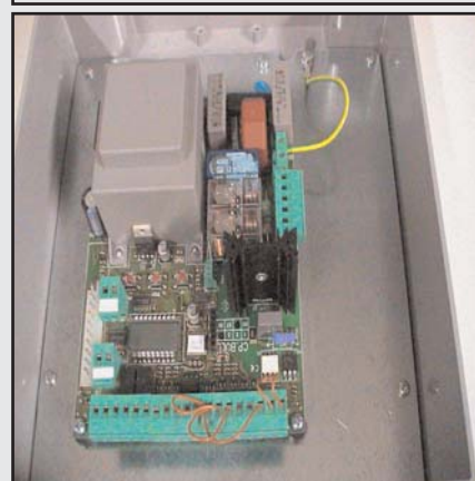
MATRIX : Coffret de commande 1 moteur 220V 500W avec fin de course. Gestion du feu de signalisation, lampe de courtoisie, serrure électrique 12V, sortie 24V pour accessoires, photocellules, bouton stop arrêt urgence, palpeurs, sécurité. Réglage de la force, du temps de travail et de pause. Programmation en automatique ou pas à pas...De nombreuses autres fonctions , affichage cristaux liquides.
