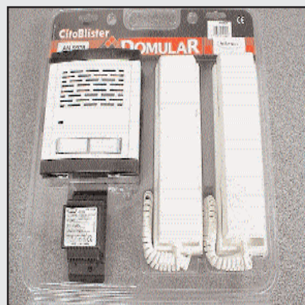
DOMULAR2E : Interphone filaire (5 fils), 2 postes, plaque de rue à encastrer laqué blanc, avec 2 boutons pour ouverture du portail et gache sur les combinés intérieurs. Très bonne phonie jusqu'à 400mètres de distance.
