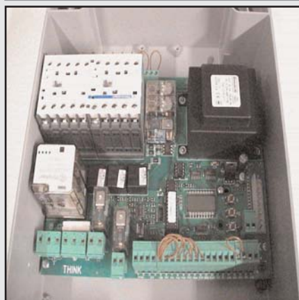
THINK : Coffret de commande 1 moteur 220V 1500W ou 400V 2200W avec fin de course. Gestion du feu de signalisation, lampe de courtoisie, serrure électrique 12V, sortie 24V pour accessoires, photocellules, bouton stop arrêt urgence, palpeurs, sécurité. Réglage de la force, du temps de travail et de pause. Programmation en automatique ou pas à pas...De nombreuses autres fonctions , affichage cristaux liquides.
