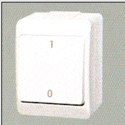
33302 : Interrupteur simple avec repère de position IP44 10A/250V blanc en saillie. Gamme HERMES.
