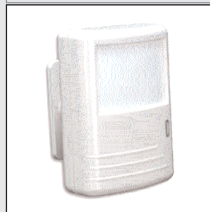
PG12 : Détecteur double technologie infra rouge / hyperfréquence 12mètres max , led de signalisation. Relais 12V, 500mA, alimentation 13.5Vcc, angle de couverture 90°. Lentille fresnel 22 faisceaux, effet doppler fréquence de travail
