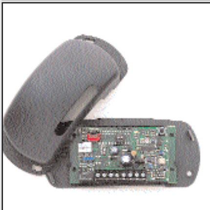
BRO22BL : Récepteur 2 fonctions 433 mhz bande large à codes variables.
