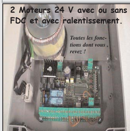
BRAIN24 : Coffret de commande pour 2 moteurs 24V il permet à 1 ou 2 moteurs en 24V de ralentir .Affichage cristaux liquides .Ce coffret s'adresse plus particulièrement aux professionnels avertis qui souhaitent avoir à leur disposition de très nombreuses fonctions.
