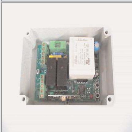
CTR29L : Kit de commande radio pour 2 circuits d'éclairage, 2 relais de 7A. 3 programmations possibles : impulsif, télérupteur et télérupteur temporisé. Il s'agit de 2 sorties en 220v
