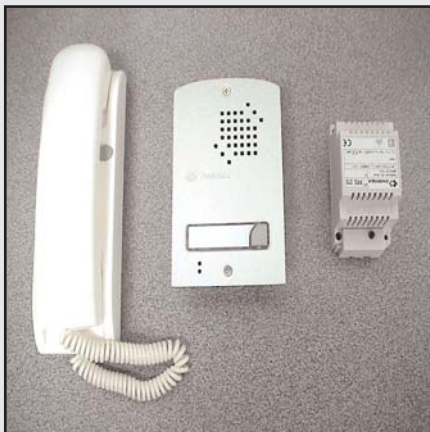
KIUP : Interphone filaire (5 fils), 1 poste, plaque de rue encastrée extra plate aluminium, avec 1 bouton 12v pour ouverture ou gache sur le combiné intérieur. Très bonne phonie jusqu'à 400mètres de distance.
