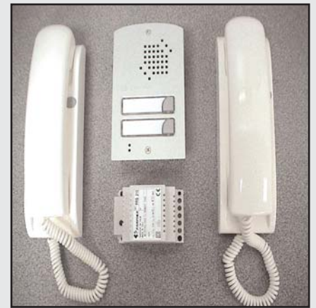
K2UP : Interphone filaire (5 fils), 2 postes, plaque de rue à encastrer en aluminium, avec 1 bouton 12v pour ouverture du portail ou gache au combiné intérieur. Très bonne phonie jusqu'à 400mètres de distance.
