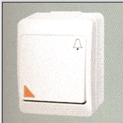
34702 : Interrupteur simple IP44 10A/250V blanc en saillie avec voyant lumineux et repère sonnerie. Gamme HER- MES.
