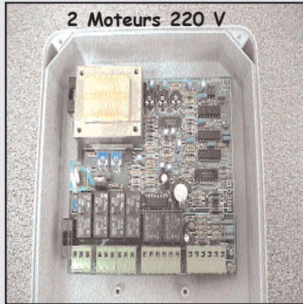
T220N : coffret de commande ancienne génération pour 2 moteurs 220v ,il permet de gérer : les cellules de sécurité , le bouton stop d'arrêt d'urgence , l'entrée start 2 vantaux , l'entrée start 1 vantail , le feu de signalisation , la serrure électrique , l'alim 24v pour les accessoires .Fonctions pas à pas et automatique . Réglage puissance , pause , décalage .Pas de compteur de mémoire .
