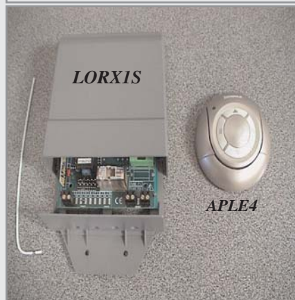
LORXIS : Circuits d'éclairage, 1 relais de 10A. impulsif, télérupteur et télérupteur temporisé il s'agit de 1 contact sec APPLE4 : Bouton poussoir radio 4 fonctions c'est une télécommande 433mhz compatible avec LORXIS .
