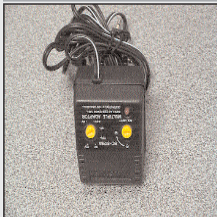
SC3128A : Alimentation universelle, entrée 220V 50Hz, sorties 3-4 ,5-6-7, 5-9-12Vdc 350mA.
