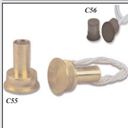
C55 : Contact magnétique à encastrer pour porte armée, sortie 4 fils. Longueur 28mm, diamètre 18mm.
