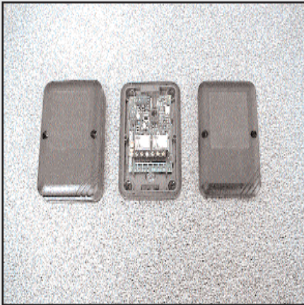
CDR861 : Cellules CARDIN 12/24vac/dc, en plastique antichoc, (dimensions 65x95x22mm). IP55. Portée à l'extérieur 10mètres.
