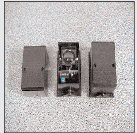
CDR841 : Cellules saillie CARDIN 12/24vac/dc, dans boîtier plastique antichoc et étanche, montée sur rotule orientable. IP55. Portée maxi 30 mètres. Existe à encastrer CDR841I .
