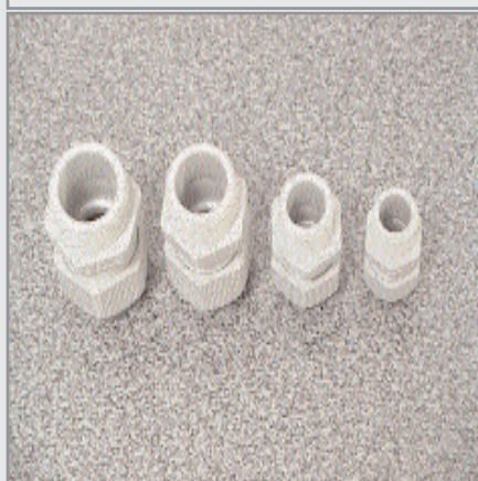
Presses étoupes : AFCPG7 : diamètre de 3 à 6.5mm . AFCPG9 : diamètre de 4 à 8mm. AFCPG11 : diamètre de 5 à 10mm. AFCPG135 : diamètre 6 à 12mm .
