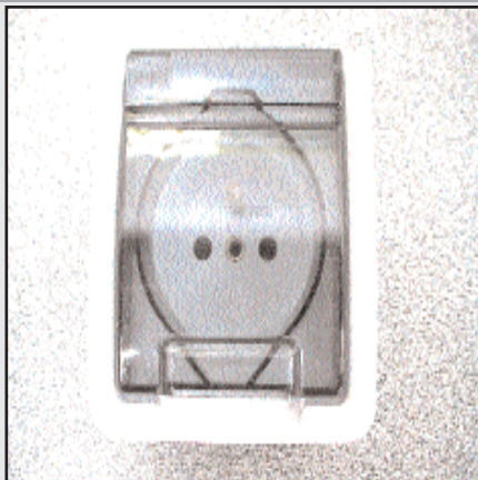
30100 : Prise de courant simple , IP44 16A/250V , bi-color capôt fumé ,avec éclips de protection enfant , en saillie.Gamme HERMES.
