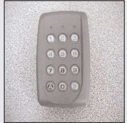
TALOS2G : clavier à codes en saillie, boîtier ABS, 2 relais NO NF, 12/24 V AC/DC, bi stable, impulsionnel, temporisé, rétro-éclairé anti-arrachement. 60 codes programmables en façade.
