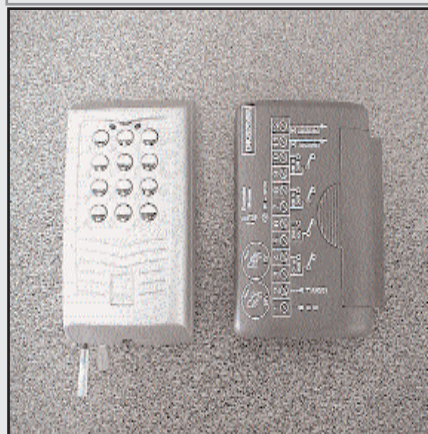
DKS250 : Clavier à codes CARDIN 12/24vac/dc, 250 codes mémorisables, IP57. 4 fonctions distinctes garantissant une inviolabilité maximum (plus d'un million de combinaisons). Electronique déportée.
