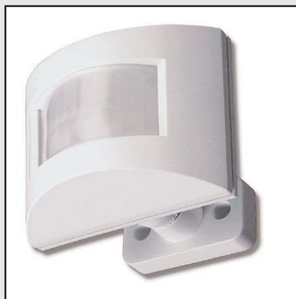
IR2 : Détecteur infra rouge passif 15 mètres maxi. 14 faisceaux sur 3 niveaux, angle de couverture 90°. Consommation 9mA en stand by, 20mA en alarme. Dimensions 90x75x70mm.
