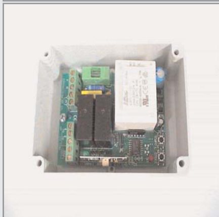
CTR29L : Kit de commande radio pour 2 circuits d'éclairage, 2 relais de 7A. 3 programmations possibles : impulsionnel, têlêrupteur et têlêrupteur temporisê . il s'agit de 2 sorties en 220v
