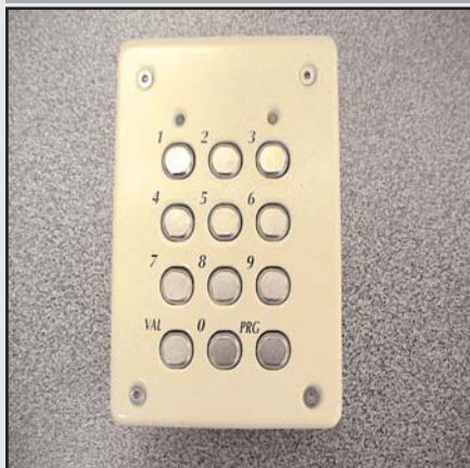
CS01 : clavier à codes 1 relais NO NF, filaire, en saillie, en acier avec touches métalliques, 12V, 10 codes programmables en façade, entrée bouton poussoir.
