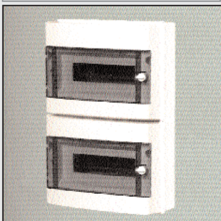
063200IP55 : Coffret 38 modules , IP55 , 525x410x150 , équipé avec porte transparente et terminal N+PE.
