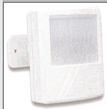
IR150 : Détecteur infra rouge 12 mètres maxi. 14 faisceaux sur 3 niveaux, angle de couverture 90°. Consommation 11mA en stand by, 15mA en alarme. Dimensions 67x77x35mm.
