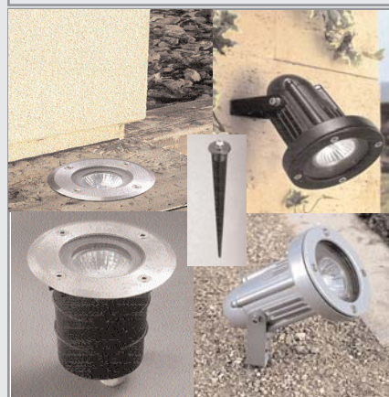
L559141Y4 : Lampe étanche encastrée en aluminium injecté, verre trempé IP65 GU-10 50W L05916505 : Spot étanche noir sailli en aluminium injecté, verre trempé IP65 GU-10 50W livré avec PIC L05916534 : Spot étanche gris sailli en aluminium injecté, verre trempé IP65 GU-10 50W livré avec PIC GU10ROBLANC : Led de puissance 2.3W blanc (5000K, 2.3w) en GU10.
