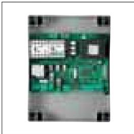
Centrale de commande jusqu'à 1500W de puissance pour un moteur à 230Vac monophasé et jusqu'à 2200W de puissance pour un moteur à 400Vac triphasé. Programmation des logiques de fonctionnement et paramètres par l'afficheur à cristaux liquides intégré. Prédilection pour récepteur radio à embrocher. Caractéristiques complètes page 150
