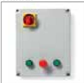
Centrales START/THINK avec boutons d'ouverture, fermeture et arrêt à accrochage et interrupteur tripolaire avec bloque porte incorporés dans le tableau de commande. Boîte résistante pour utilisation en environnement industriel, indice de protection IP 55.
