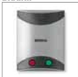
Centrale de commande 230 Vac pour 1 ou 2 moteurs pour portes battantes, coulissantes ou fermetures industrielles. Afficheur intégré, nombreuses logiques de fonctionnement. Prédisposée pour récepteur radio embrochable. Possibilité d'afficher le nombre de manoeuvres effectives. Caractéristiques complètes page 144
